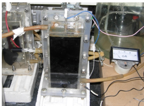
图 1 双极室 MEC 反应器 Figure 1 Cuboid MEC reactor
