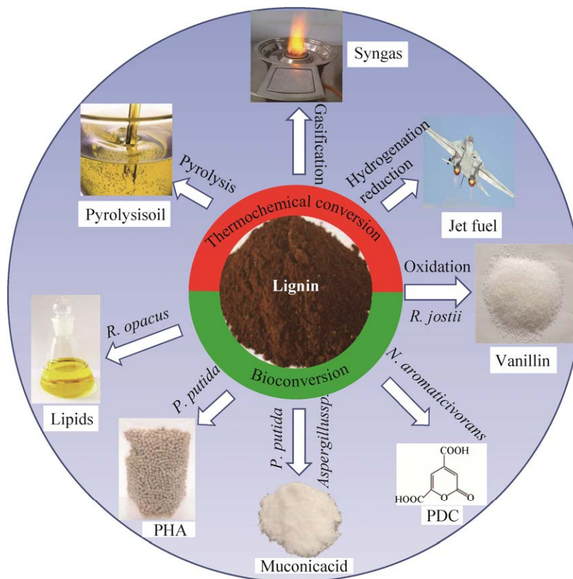
图4 木质素热化学转化和生物转化过程及产品
