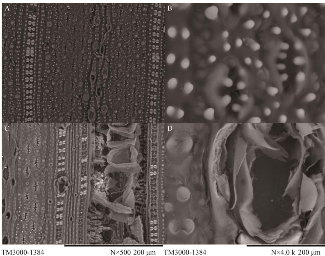
图 9 菌株 N5 对水稻秸秆降解的扫描电镜 A: 500 倍下未经处理的秸秆. B: 4 000 倍下未经处理的秸秆. C: 500 倍下经过 N5 处理的秸秆. D: 4 000 倍下经过 N5 处理的秸秆
