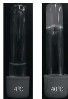
图4 PNIPAAm水溶液在4°C和40°C时的性状
